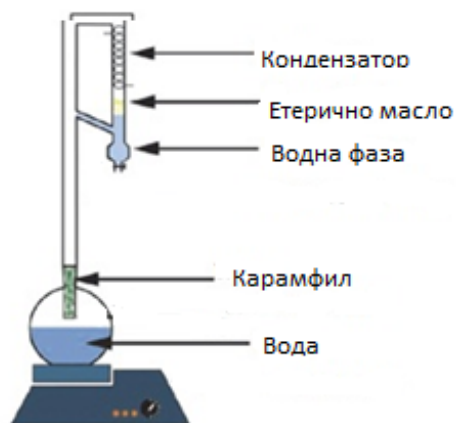
Фигура2. Принципна схема на парна дестилация [27]
