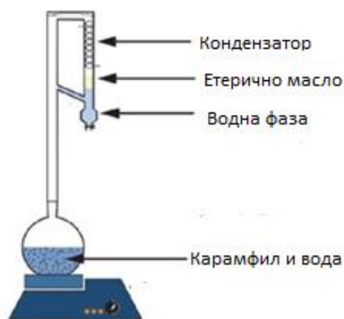
Фигура 3. Принципна схема на хидродестилация [27]
