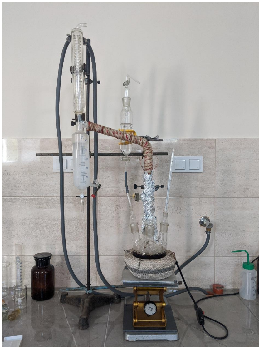
Фигура 12 Снимка на опитна инсталация за получаване на етерично масло чрез хидродестилация
